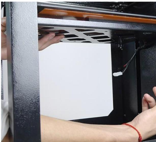
2.4) Подключите провода питания и кабель передачи данных платформы как на картинке.
