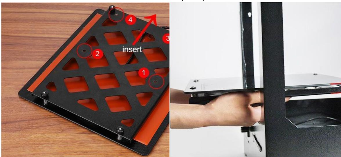
2.3) С помощью отвертки в комплекте закрутите винты для фиксации рабочего стола и направляющих
