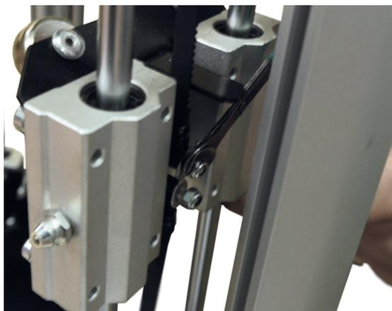
Натяните ремни с помощью регулировки подшипников и прижмите винтами к профилям
