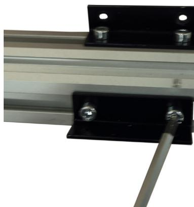
Вкрутите крепежные уголки профиля к крышке, затяните их винтами М4х6 к вкладышам в профиль
